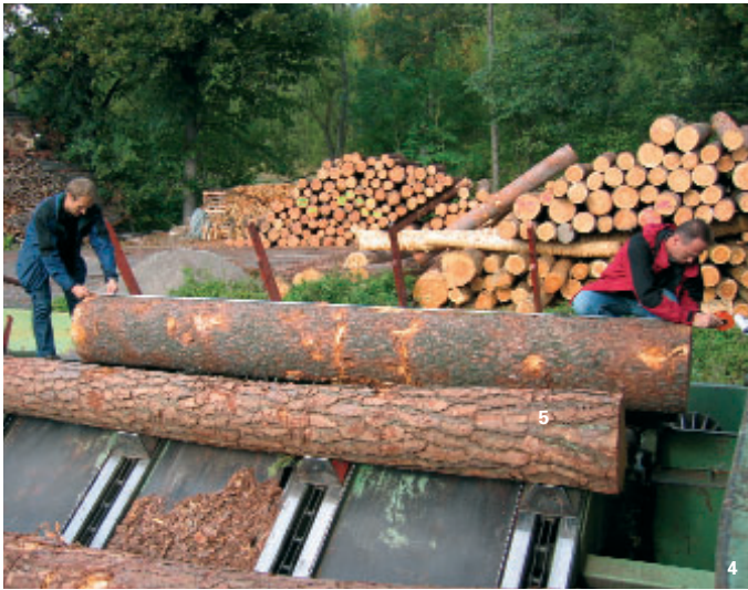
4 Kontrolle der Längenmessung am Rundholzplatz des Sägewerkes
