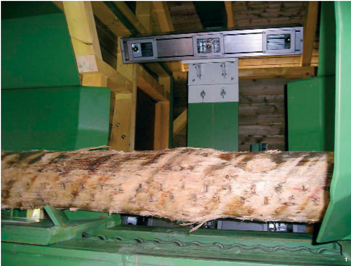
1 Elektronische Rundholzvermessung – diese Schnittstelle von Forst – Säge durchläuft Holz mit einem geschätzten Wert von 1 Mrd. Euro pro Jahr
