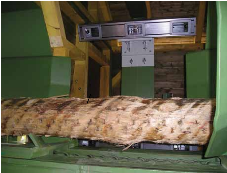
2 Laserscanner für die Ermittlung der Oberflächeneigenschaften, aufgrund derer das Gittermodell im Computer interpoliert wird.
