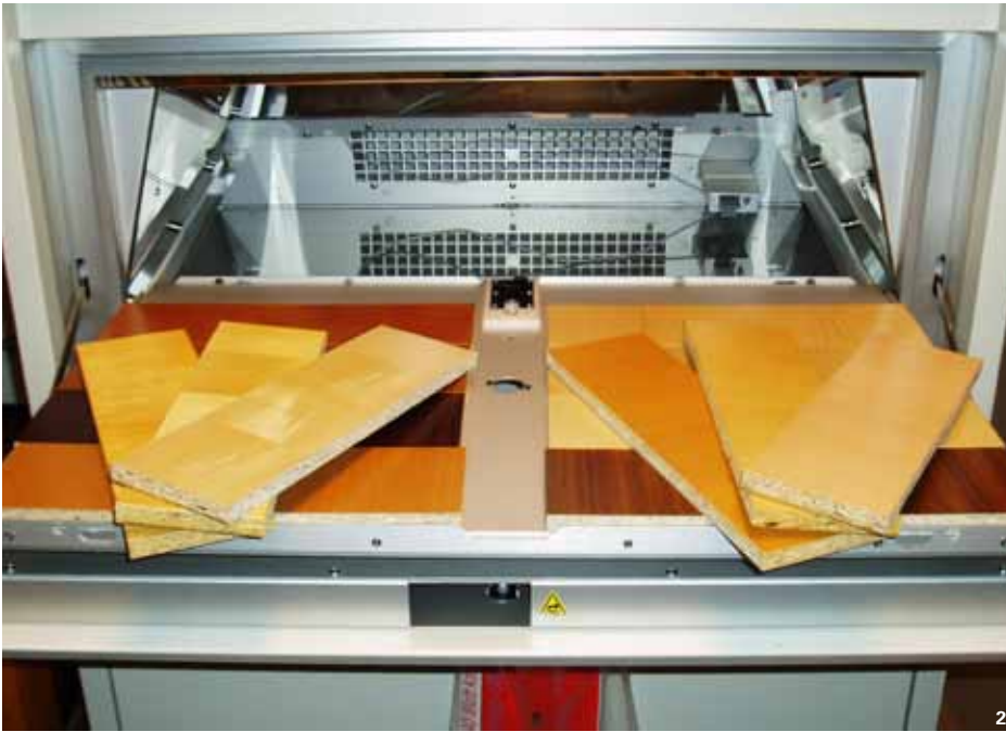
2 Die Proben wurden in kurzer Zeit unter einer Xenon-Bogenlampe hohen Lichtbelastungen ausgesetzt.
