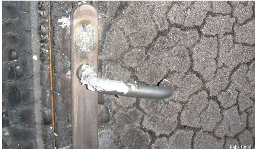
Drückergarnitur gemäß ÖNORM B 3859 nach Brandprüfung.
