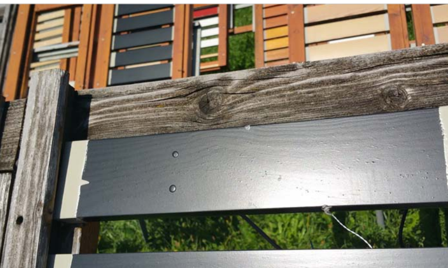
Bewitterung und Temperaturmessung einer Beschichtung mit „Cool Pigments“ am Freilandstand der Holzforschung Austria in Wien.
