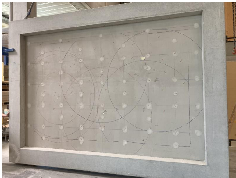
Abbildung 17: Senderaumseitige Ansicht der geprüften Stahlbetonwand mit 140 mm Stärke.
