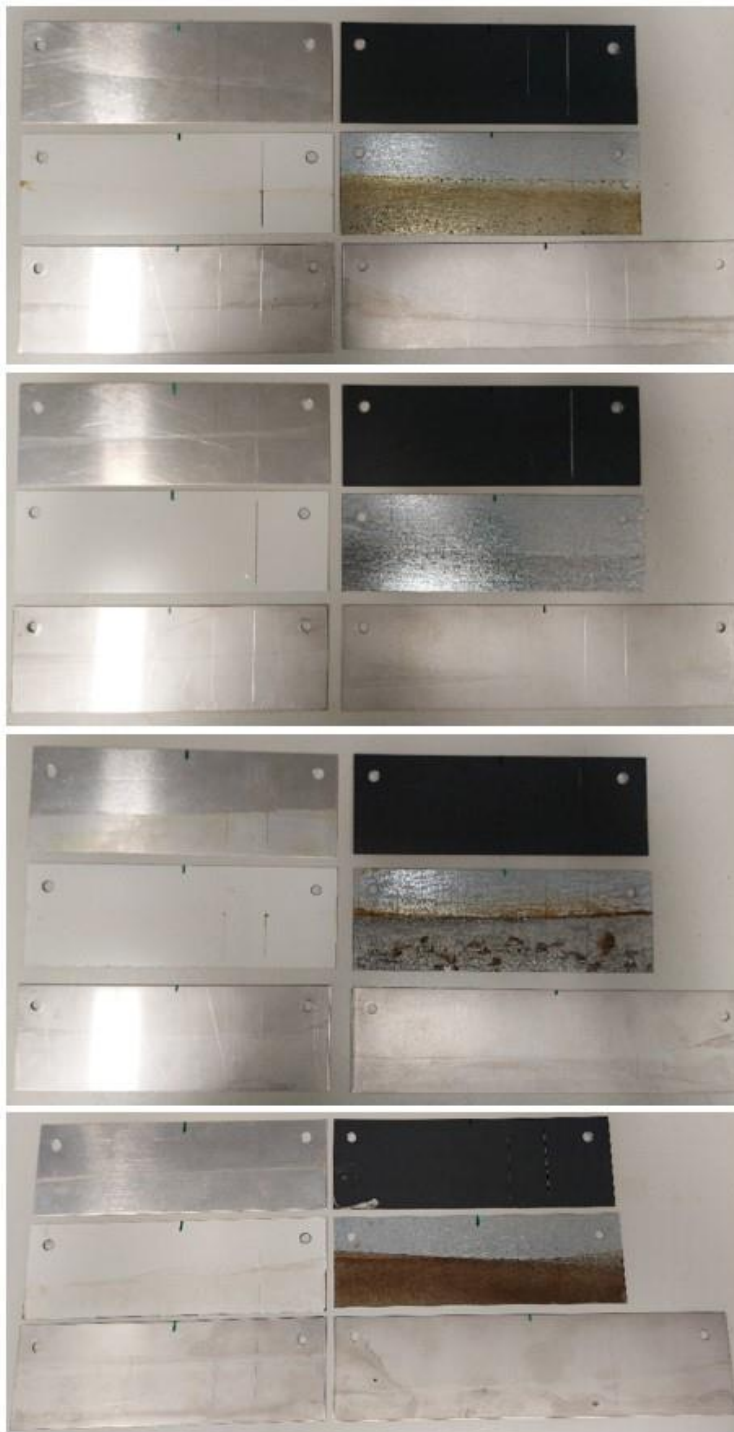
Abbildung 24: Veränderungen der Blechoberflächen nach 28 Tagen Korrosionsversuchen, Reihenfolge von oben: Lärche gehobelt, Fichte, Eiche, Thermofichte, jeweils: 1. Reihe: Aluminium (Al), Aluminium beschichtet (AlB), 2. Reihe: verzinktes Blech beschichtet (VzB), verzinktes Blech (Vz), 3. Reihe: Edelstahl V2A (V2A), Edelstahl V4A (V4A)
