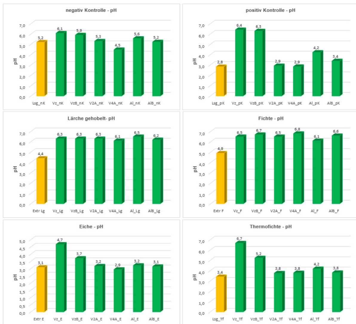
Abbildung 21: Vergleich der pH-Werte der Originallösungen/-extrakte (orange) zu den Lösungen nach 28 Tagen small-scale Korrosionsversuch mit den unterschiedlichen Blecharten (grün)
