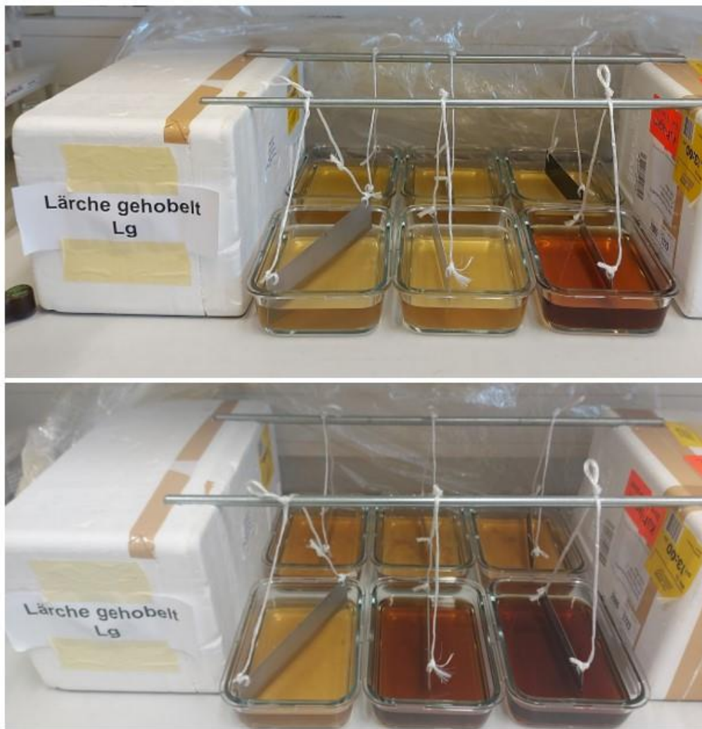
Abbildung 18: Nachdunkeln des Lärchenextraktes im Laufe des Versuches, oben: Aufbau Lärchenextrakt am Tag 7; unten: Aufbau Lärchenextrakt am Tag 28, vorne rechts: verzinktes Blech, vorne Mitte: verzinktes Blech beschichtet
