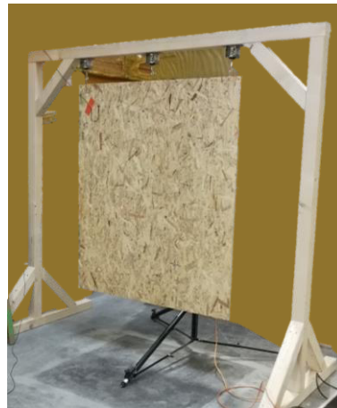
Abbildung 27: Bei der Modalanalyse der Werkstoffe wurden diese elastisch aufgehangen (hier: OSB).
