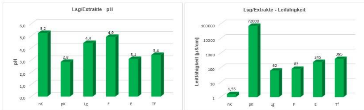
Abbildung 19: Vergleich der pH-Werte und der Leitfähigkeiten der Originallösungen/-extrakte
