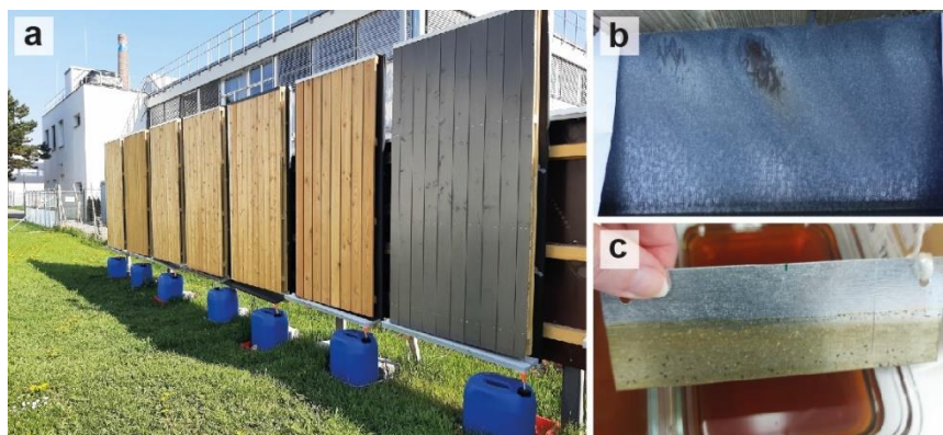
Abbildung 41: (a) Freilandversuch (b-c) Korrosion an einem unbeschichteten, verzinkten Blech in Kombination mit Lärche, nach 15 Monaten in der Freilandbewitterung (b) und nach 28 Tagen im Schnellbewitterungslaborversuch (c)
