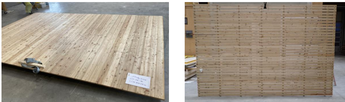
Abbildung 10: Linke Seite: Lärche Nut+Feder Fassade vertikal ausgeführt mit Kreuzlattung (SV1). Rechte Seite: Lärche Rhombusleisten horizontal ausgeführt nur mit Traglattung (SV2).
