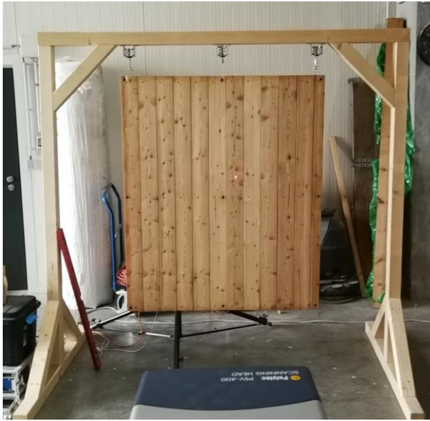
Abbildung 3: Zur Ermittlung der Materialeigenschaften wurden die Bauteile elastisch aufgehängt und die Schwingungen mittels Laservibrometrie gemessen.
