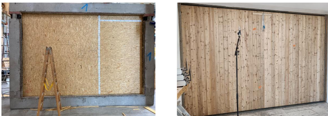
Abbildung 15: Links: Empfangsraumseitige Ansicht der Holzrahmenwand im Prüfraumen. Rechts: Senderraumseitige Ansicht der im Prüfstand eingebauten Grundwand mit Nut-Feder Lärchenschalung.
