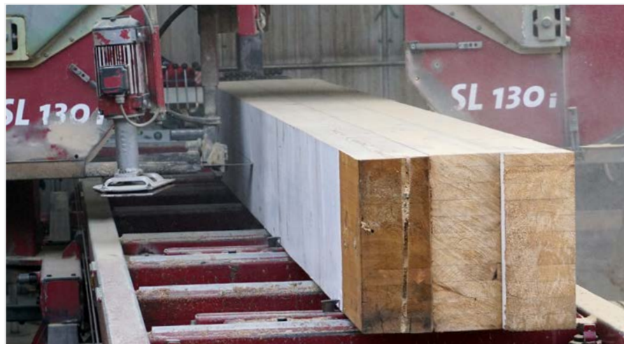
Remanufacturing eines gebrauchten und beschichteten Brettschichtholzträgers
