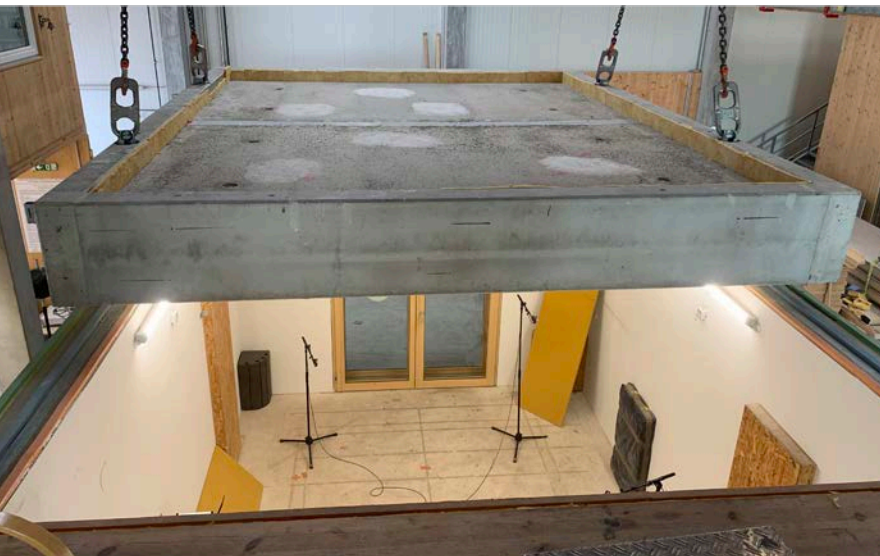
Einheben einer Hybrid-Flachdecke in den Prüfstand im Akustik Center Austria der Holzforschung Austria am Standort Stetten.
