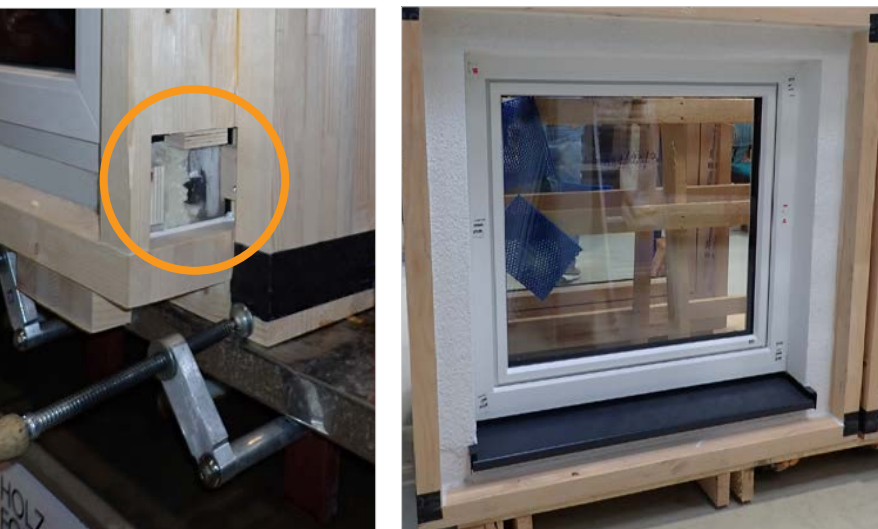
Links: Prüfkörper mit Sichtfenster am Prüfstand; Rechts: Ansicht eines Prüfkörpers: PVC-Fenster, WDVS mit Anschlussprofil mit Selbstklebung und eingeputzter Alu-Fensterbank
