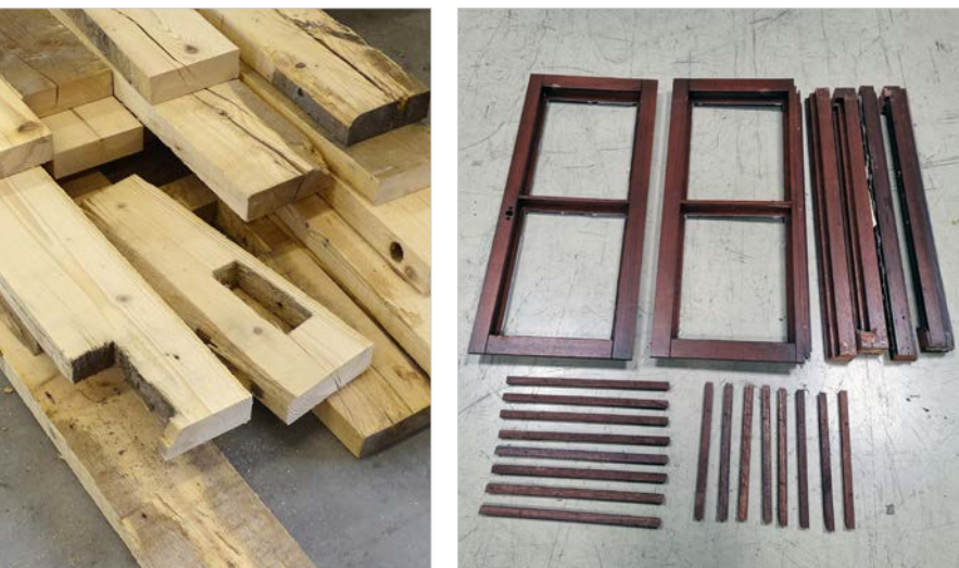
Links: Altholz als Halbfabrikat; rechts: Zerlegung kleinvolumiger Holzbauprodukte im Zuge der Analyse des Aufwandes und der Ausbeute
