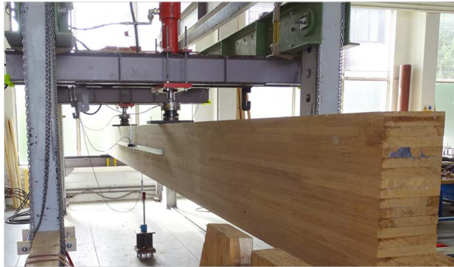
Eichenbrettschichtholz im 4-Punkt-Biegversuch mit einer Länge von ca. 10 Metern
