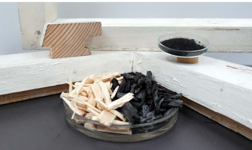
Zirkuläre Altfensterverwertung durch Pyrolyse
